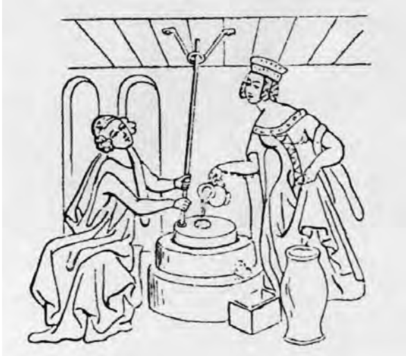
Fig. 11 - Mulino rotativo a barra con direzione fissa, immagine tratta da "BENNETT R. - JOHN E., History of Corn Milling, Volume I. Handstone, Slave & Cattle Mills, London 1898, p. 163", Manoscritto tedesco del XIV secolo.
