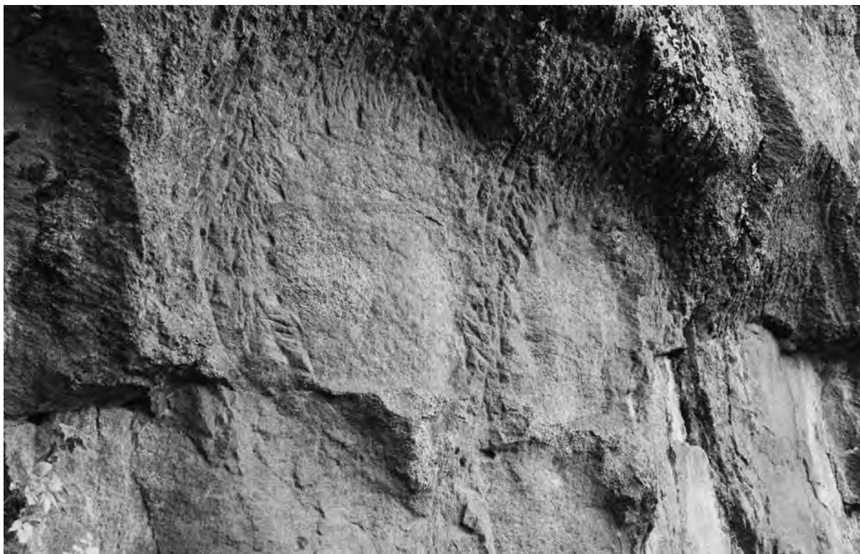
Fig. 3 - Vallone di Saint-Marcel (AO). Località Fontillon. Fronte di estrazione con alveoli di distacco e tracce dei fori per l'inserimento dei cunei lignei.
