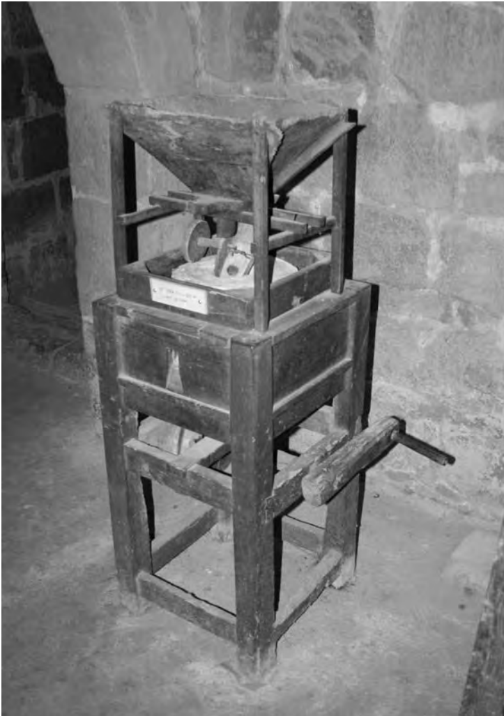
Fig. 14 - Mulino a ingranaggi mosso da una manovella, Malta – Isola di Gozo, Interno del mulino a vento di Ta' Kola (2010).
